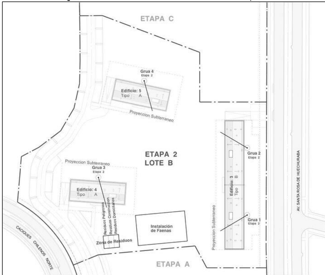
Imagen N° 7: Instalación de faena fase de construcción etapa N° 2
