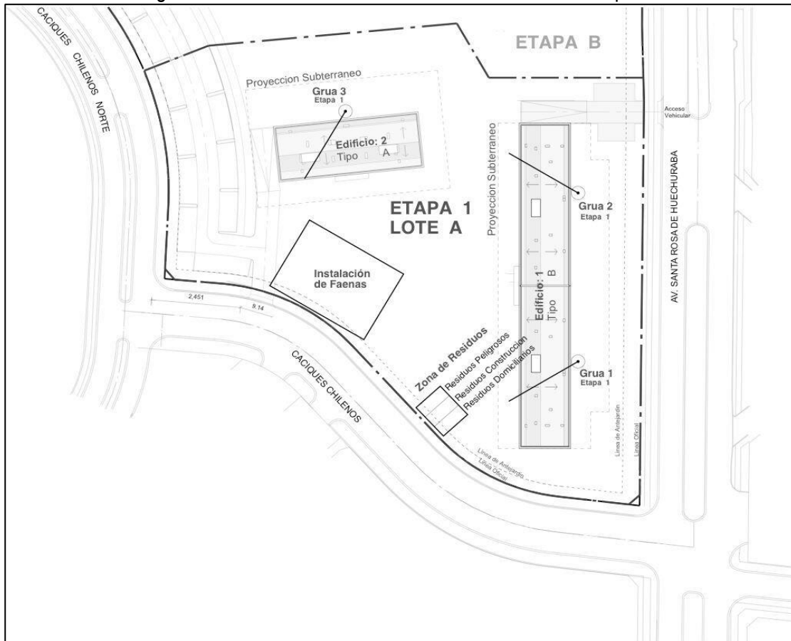
Imagen N° 6: Instalación de faena fase de construcción etapa N° 1
